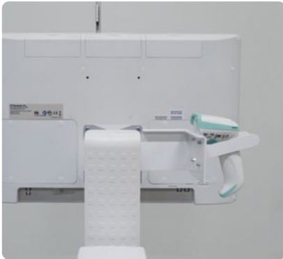
Scannerhouder linksachter De barcodescanner is links van het beeldscherm te bereiken.
