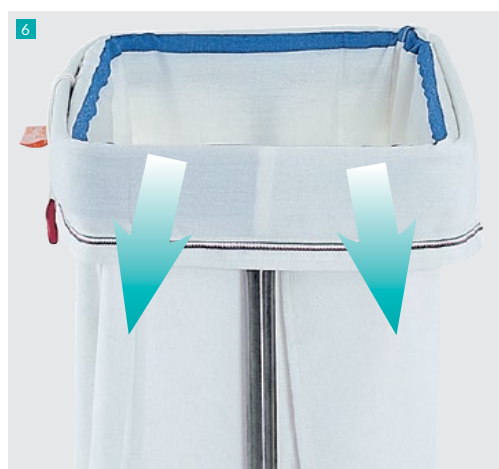
Pour enlever le sac, tirez simplement les bords du sac vers le bas. Cela dépliera l'anneau de maintien vers le bas et libérera le sac.
