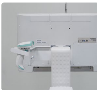
Scannerhalterung hinten rechts Der Barcodescanner ist rechts vom Bildschirm zu erreichen.
